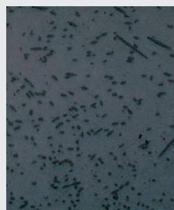
термопластичный сухой материал получен путем впрыскивания с гомогенными добавками
