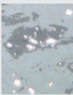
термопластичный сухой материал получен путем впрыскивания с гомогенными добавками
